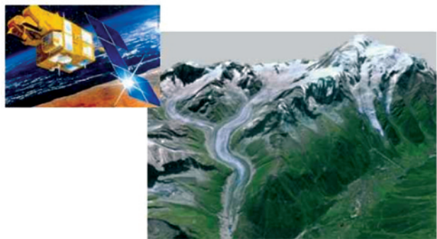
Figure 1 : L'imagerie satellitaire au chevet des glaciers de montagne. Les images du satellite SPOT5 (en vue d'artiste à gauche) combinent une couverture large (60*60 km) à une haute résolution (2.5 m) et sont donc adaptées pour le suivi des glaciers comme ceux du massif du Mont Blanc. L'image SPOT5 a été ici drapée sur une topographie pour réaliser cette vue perspective où l'on distingue l'ensemble de la Mer de Glace, le sommet du Mont Blanc en arrière-plan et la vallée de Chamonix.
